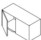
Mobile pensile con ante battenti - Maniglia sul lato inferiore • Hanging cabinet with hinged doors - Handle on the bottom • Hängeschrank mit Flügeltüren - Griff an der Unterseite • Meuble suspendue avec portes battantes - Poignée en bas • Mueble suspendido con puertas abatibles - Tirador en la parte inferior
