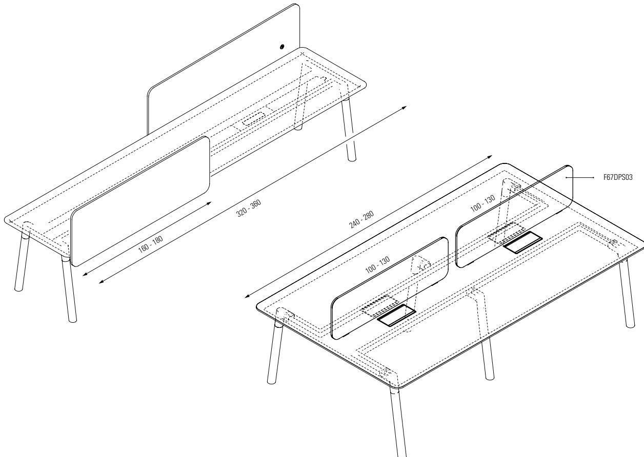
Le scrivanie extralong hanno le stesse caratteristiche delle scrivanie singole, tuttavia possono essere configurate, grazie al design delle travi sottopiano, in dimensioni importanti. La lunghezza massima del piano arriva a 360 cm, utilizzando solo 4 gambe. Le scrivanie multiple invece, sono dotate di 6 gambe e hanno P160. Date le dimensioni di queste scrivanie, non è possibile realizzarle in impiallacciato.
