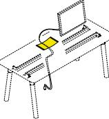
Pad portacavi in tessuto, con aggancio in Velcro • Fabric cable pad, with Velcro fastening • Kabelunterlage, mit Klettbandbefestigung • Pad porte-câbles en tissu, avec accrochage en Velcro • Pad portacables en tela, con enganche de Velcro
