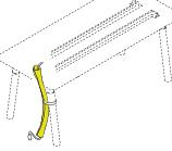
Canalina salitacavi in tessuto • Fabric cable riser duct • Kabelkanal aus Textil • Goulotte de remontée de câbles en tissu • Conducto de subida cables de tela
